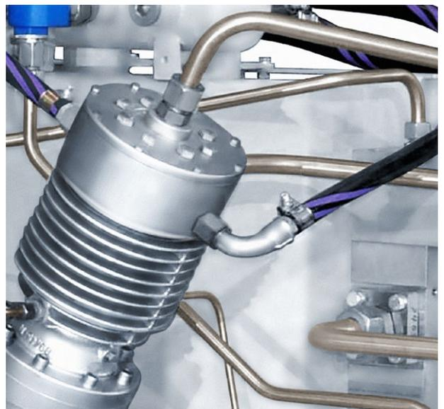
Головка клапана с водяным охлаждением
