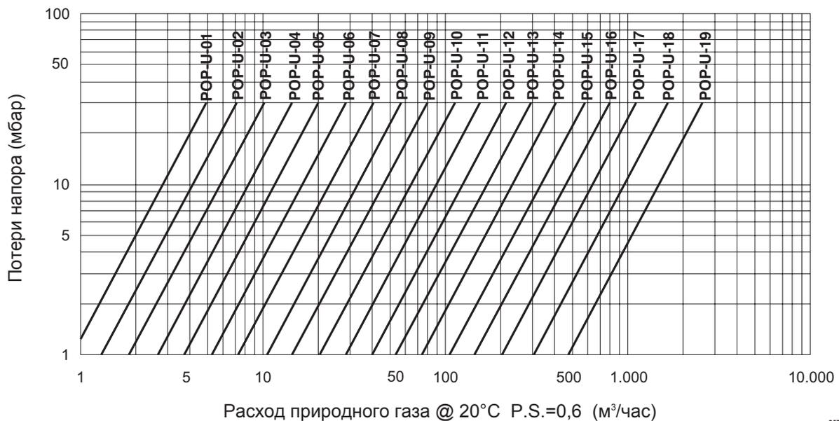
Представленные в диаграммах характеристические кривые указывают расходы в Нм³/час, относящиеся к потерям напора в мбар для соответствующих стандартных отверстий; кривые относятся к атмосферному давлению (1,013 бар) и к температуре жидкости 20°C. Для измерения расхода относительно других ,
