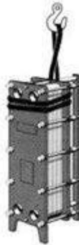
Строповка теплообменника без транспортных отверстий
