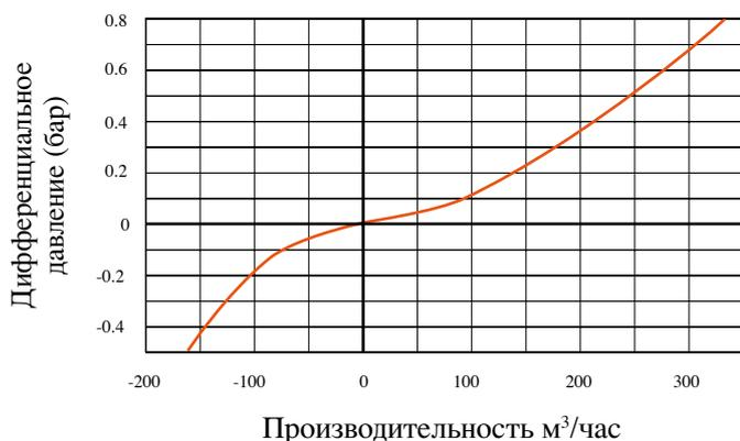
**График пропускной способности в автоматическом режиме**
