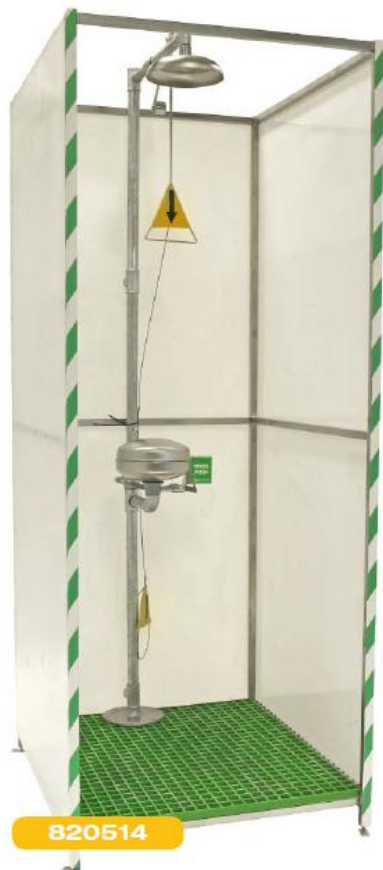
820514 Душевая кабина, подходящая к комбинированным душам. Панели из PV пластика и рама из нержавеющей стали. Размеры 940x1050x2400 мм
