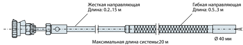
D-LL 703: опволоконная система с гибкой направляющей для датчика пламени D-LE 703 и монитора пламени D-LX 700
