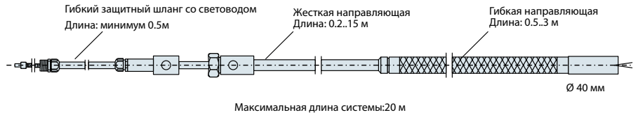
D-LL 701: опволоконная система с гибкой направляющей для датчика пламени D-LE 701
