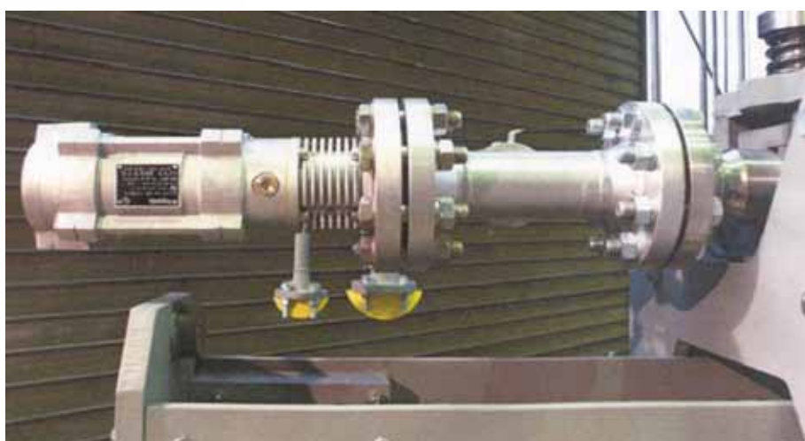
Запальники для работы в топках под высоким избыточным давлением (до 64 бар)
