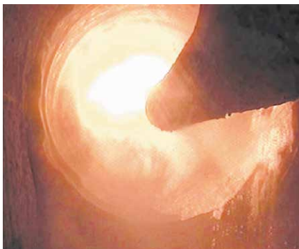
Видеоизображение из вращающейся печи
